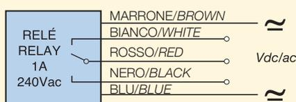
Tensione di alimentazione: lo stesso sensore può essere alimentato da 18÷50 Vcc e da 18÷240 Vca.
